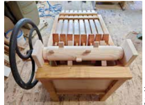
Die Turmratsche kurz vor ihrer Fertigstellung
